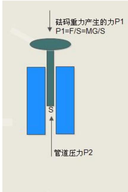
由于在天平的工作中，管道压力  $P_2$  介质往往是水压，里面可能夹杂石头，沙子等，而天平属于精密仪器，天平的活塞杆和活塞缸之间不能有任何杂物，所以在这个原理上引进了液体静态压力平衡，通过压力转换巧妙的保护活塞系统。
